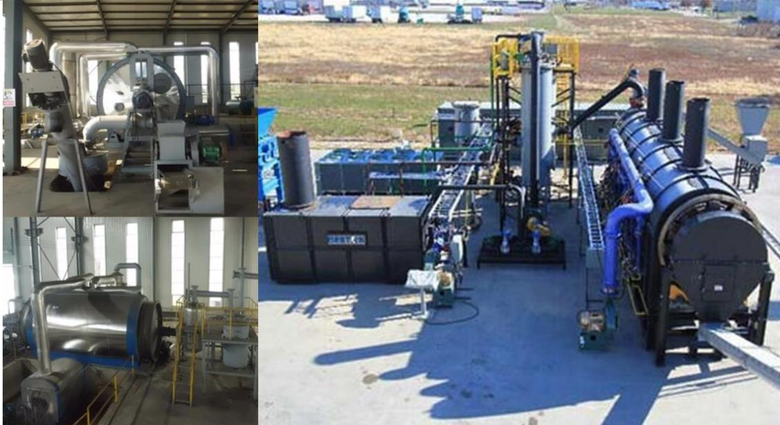
Pirólisis. En la imagen izquierda se puede apreciar dos vistas de un reactor de Pirólisis, y en la imagen derecha, una planta de Pirólisis de neumáticos.
