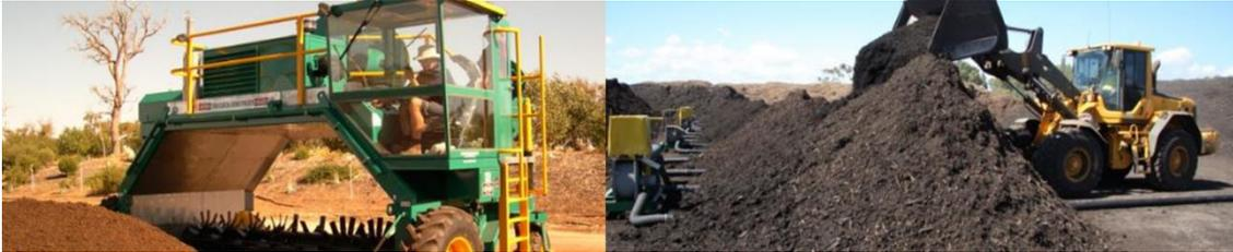
Operación de una planta de compostaje. En la imagen izquierda se puede apreciar un volteador autopropulsado, y en la imagen derecha, un cargador frontal realizando el volteo de las pilas.
