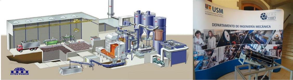
Gasificación. En la imagen izquierda se puede apreciar un esquema de una planta de Gasificación, y en la imagen derecha, el reactor piloto que se presentó en el proyecto FIC-R 2017 GasBas.
