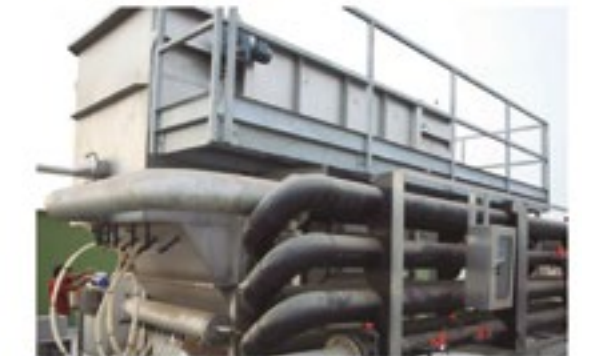
PTAR Nestlé D'Onofrio Lima DAF 100 m 3 /h.
