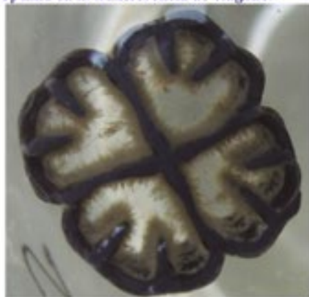
Portador Aqwise. Desarrollo biofilm en superficie interna
