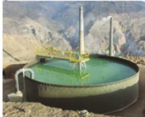
Tanque ecualizador con agitador hiperbólico. Fundición Caletones, CODELCO, Chile
